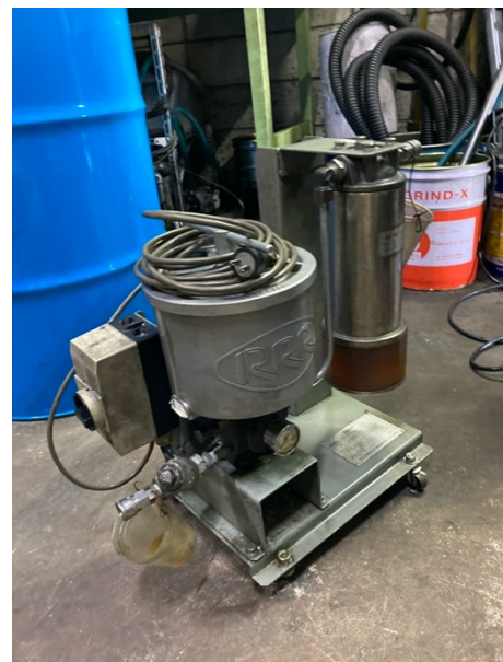
廃油をこの装置でろ過する
